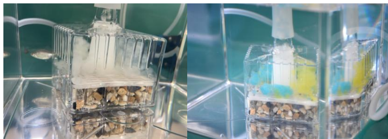
図 6 改良エアレーション（左：無搭載 右：ビーズ搭載）
