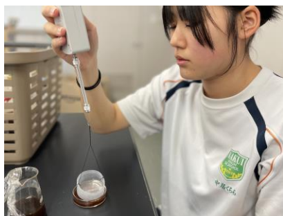
図 11 表面張力の簡易測定（左：測定の様子 右：測定のイメージ図）
